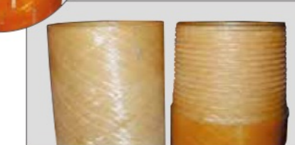
特殊ネジの採用により、アップセット部無しに同一径化されたフラッシュジョイントのファイバーガラス・ケーシング両端部
